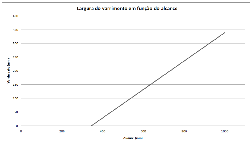
Figura 3.12: Gráfico representativo da largura de varrimento em função do alcance.
