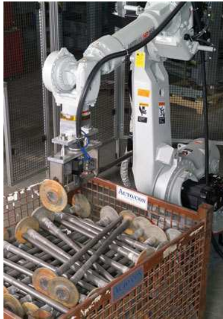
Figura 1.3: Sistema de bin-picking da Auto/Con Corp..
